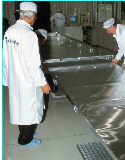
Il Contenitore, o Teca, dove alloggia la tavola scorrevole ed estraibile, sul quale la Sindone viene mantenuta fissata in posizione distesa.
