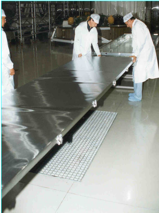
Il Contenitore, o Teca, dove alloggia la tavola scorrevole ed estraibile, sul quale la Sindone viene mantenuta fissata in posizione distesa.
